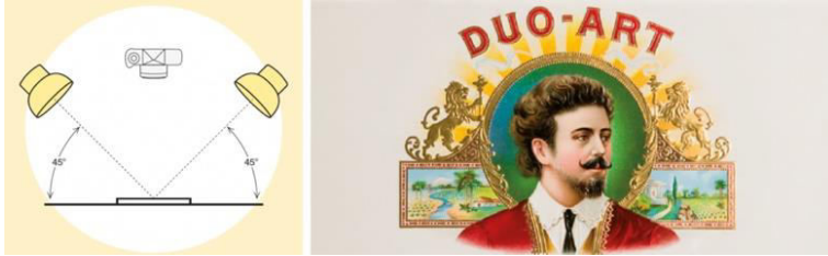
Görsel 2: Yansıma açıları dışında konumlandırılmış "sağ-sol" iki ışık kaynağı Kaynak: (Hunter & Biver, v.d.)
