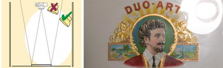
Görsel 1: Yansıma açıları içerisine konumlandırılmış tek ışık kaynağı Kaynak: (Hunter & Biver, v.d.)
